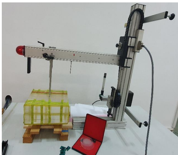
Rysunek 4.10. Stanowisko pomiarowe Beta Secondary Standard 2: stelaż z umieszczonym źródłem, filtrem spłaszczającym i fantomem płytowym.
