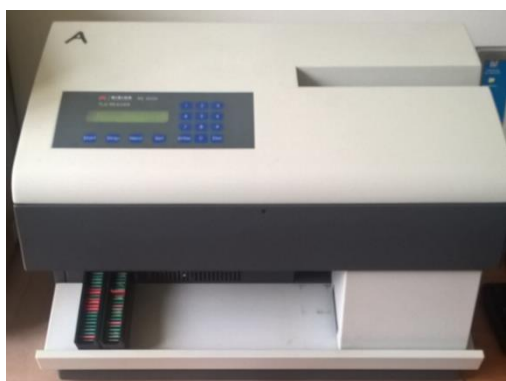
Rysunek 4.3. Czytnik termoluminescencyjny RADOS 2000 (po lewej stronie) i piec TLDO (po prawej stronie).
