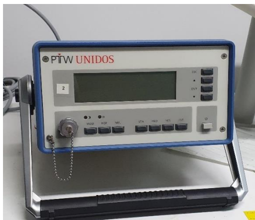
Rysunek 4.9. Dawkomierz uniwersalny PTW-UNIDOS oraz komora jonizacyjna LS-01 typu 32002.
